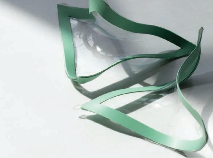
Potenzielles Element einer Fassade mit dielektrischen Elastomeren
