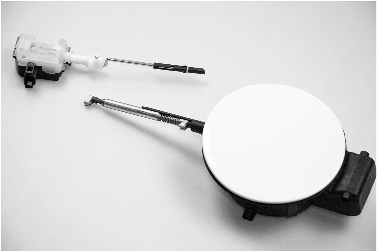
Abbildung 3: In der Tankklappe werden Smart Materials als Substitut für einen Motor eingesetzt, um den Entriegelungsmechanismus auszulösen.
